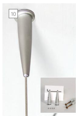
tirante per cavi fly loop per fissaggio a soffitto. ottone color argento satinato, per cavi di acciaio con spessore max. ø2mm, materiale di montaggio incluso
