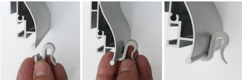
agganciare le clip al profilo, nella quantità desiderata, prima o dopo il montaggio della struttura; gancio per elastico che ne semplifica l'assemblaggio e lo mantiene perfettamente in tensione.
