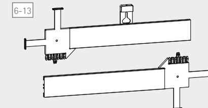
2 profili in alluminio anodizzato color argento, 2 angolari in materiale plastico, quantità necessaria per livellatura a parete
