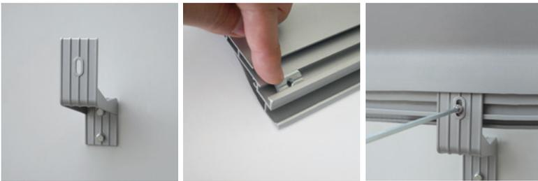
montare il gancio a parete, fissare i dadi nel profilo - siccome non vengono inseriti nella cava, è possibile aggiungerne anche dopo aver terminato il montaggio della struttura. fissare il profilo al gancio. distanza dalla parete del banner: 130mm
