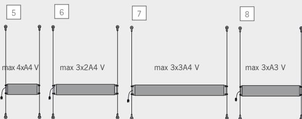
trasformatore kit: 4pz supporti per cavo, cavo d'acciaio 1x5m, spina, trasformatore in contenitore alluminio color argento con fissaggi per cavo, per montaggio libero su cavo
