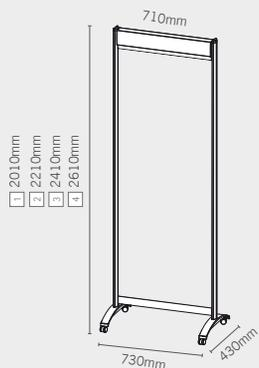
struttura mobile soistes in alluminio anodizzato color argento, connettori in metallo pressofuso, con ruote e sistema wallup.
