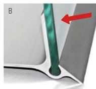
inserire il pannello inclinato in avanti, spingere all'indietro per fissarlo al biadesivo premontato
