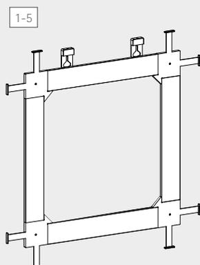
4 profili in alluminio anodizzato color argento, 4 angolari in materiale plastico, quantità necessaria per livellatura a parete e una cacciavite
